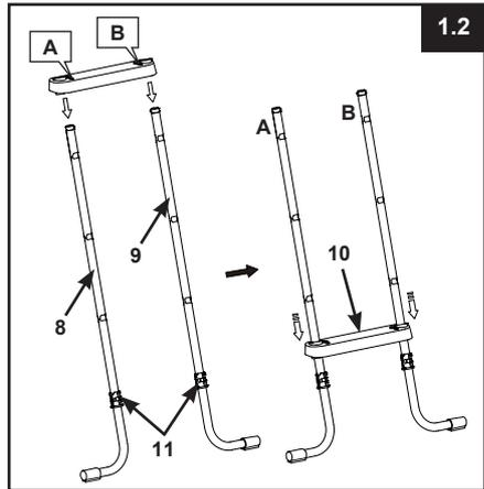
**WICHTIG:** Versichern Sie sich, dass die J-förmigen FüÙe nach auÙen schauen, bevor Sie die Stufen montieren.
