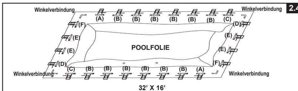
3. Vergewissern Sie sich, dass die Poolfolie geöffnet ist und in ihrer vollen Größe auf der Unterlagsplane ausgebreitet wurde. Beginnen Sie auf einer Seite, stecken Sie die "A" Stangen zuerst in die Laschenöffnungen, welche sich in jedem Eck befinden. Fahren Sie mit den "B" Stangen fort, stecken Sie diese mit den "A" Stangen zusammen. Die "C" Stangen gehören wiederum mit den "B" Stangen verbunden (**siehe dazu Zeichnung 3**).
