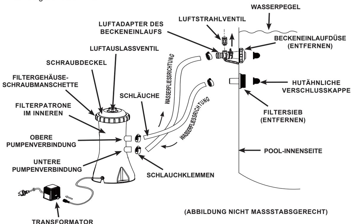
Der Netzkabelstecker der Filterpumpe für die 220-240 Volt Stromquelle muss mehr als 3,5 m von den Pool-Wänden entfernt positioniert werden. Kontaktieren Sie Ihre lokalen Behörden bezüglich der entsprechenden Standards und Anforderungen zu der „Elektrischen Installation von Schwimmbädern und Beckenausrüstungen“. Die folgende Tabelle dient lediglich als Referenz.
