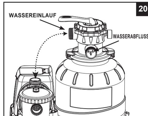
2. Setzen Sie einen L-förmigen O-Ring (11) auf den Einlassanschluss des 6-Wege-Ventils und einen L-förmigen O-Ring (18) auf den Auslass des Pumpenmotors. Befestigen Sie im Uhrzeigersinn den Sandfilter-Verbindungsschlauch (13) zwischen dem Pumpenmotorabfluss und dem Einlaufstutzen des 6-Wege-Ventils (siehe dazu Zeichnung 21).
