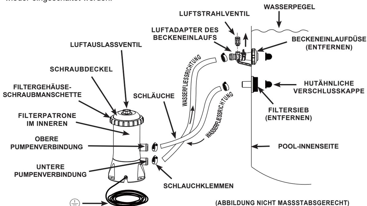
Der Netzkabelstecker der Filterpumpe für die 220-240 Volt Stromquelle muss mehr als 3,5 m von den Pool-Wänden entfernt positioniert werden. Kontaktieren Sie Ihre lokalen Behörden bezüglich der entsprechenden Standards und Anforderungen zu der „Elektrischen Installation von Schwimmbädern und Beckenausrüstungen“. Die folgende Tabelle dient lediglich als Referenz.
