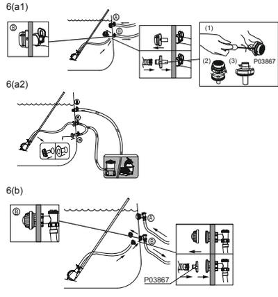
**BITTE BEACHTEN:** Geliefert wird ein Schlauchadapter zur Verwendung mit Ihrem Pool. (Siehe Schritt 6a1) Wenn sich zwei Auslassventile an Ihrem Pool befinden, schließen Sie bitte eines der Ventile. (Siehe Schritt 6a2)
