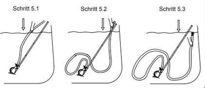
**WICHTIG:** Platzieren Sie den Sauger im Wasser und füllen Sie den Absaugschlauch mit Wasser, um jegliche Luft zu entfernen. Befolgen Sie die 3 Schritte in Abbildung 5. Benutzen Sie den Vakuumsauger nur, wenn der Schlauch vollständig mit Wasser gefüllt ist.
